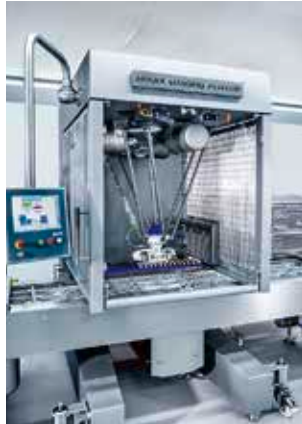
Loading system Typ V-G-E – zum Einlegen von Produkten direkt in die Verpackungsmaschine
